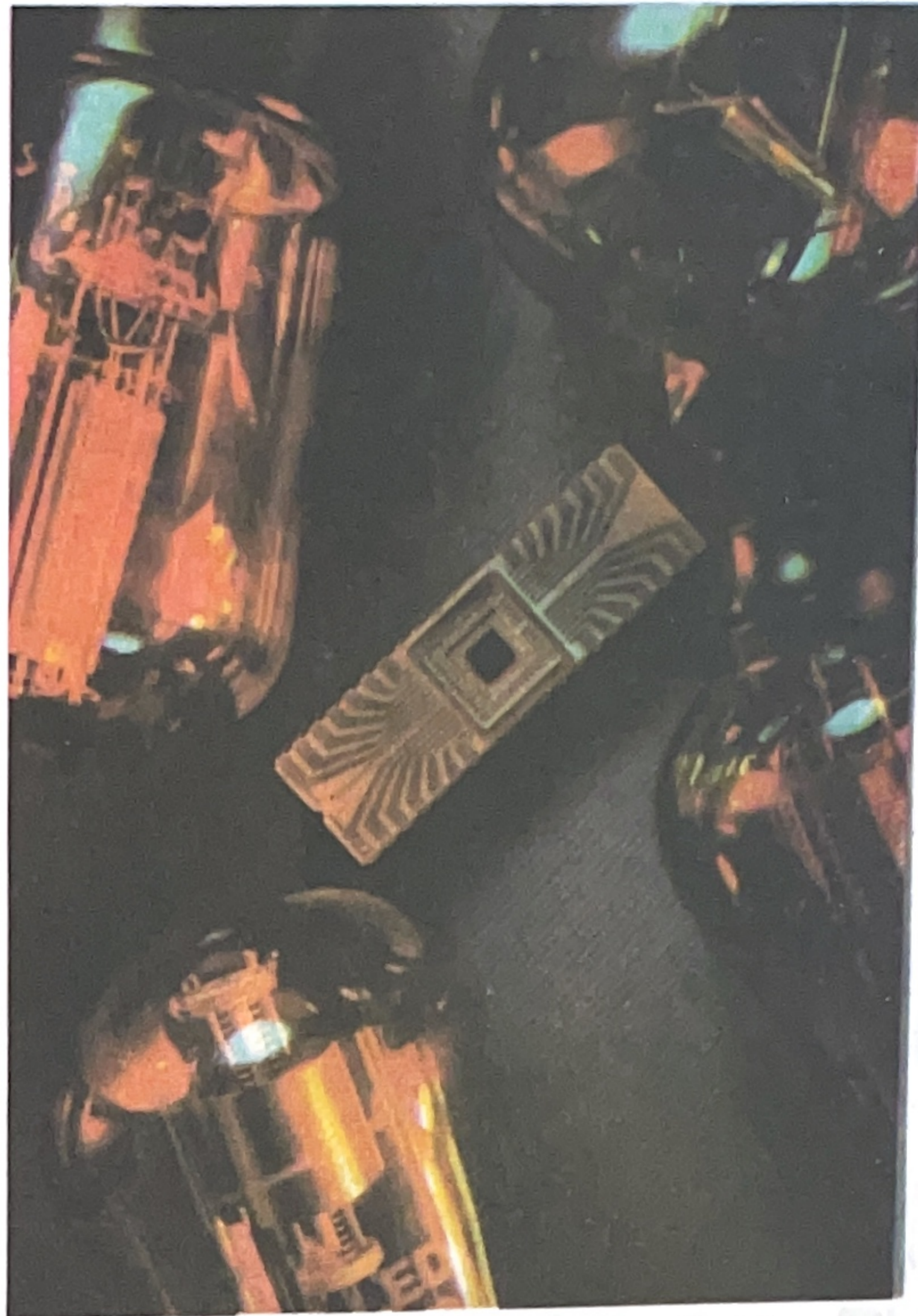
Kamen temeljac revolucije u obradi podataka: Razvoj savremenih računara zasniva se na jeftinom i moćnom mikroprocesoru (na slici: mikroprocesor u poređenju sa elektronskim cevima)
